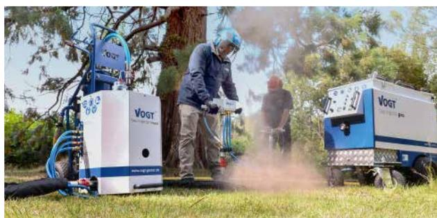
Das Bodenbelüftungsgerät soll verdichtetes Erdreich lockern, um so das gehemmte Wurzelwachstum wieder anzuregen.
