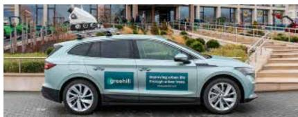
Das Elektrofahrzeug trägt den LiDAR-Scanner mit der Greehill Technologie auf dem Dach
