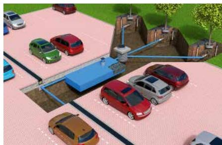
*Funke Kunststoffe sorgt für die Reinigung und Ableitung von Oberflächenwasser zum Baumstandort.*
