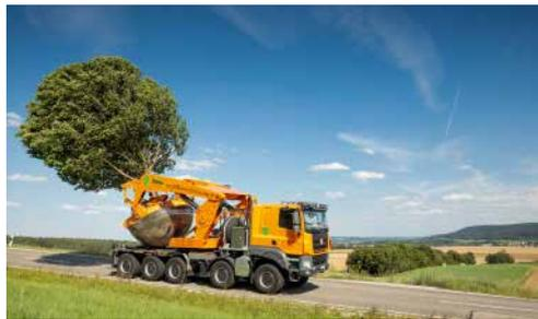
Die eigens entwickelte Rundspatenmaschine Optimal 3000 plus verpflanzt Bäume mit einem Stammumfang von bis zu 150 cm.
