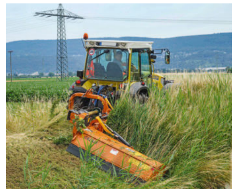
Der Berti Universalmulcher TA/PS ist für den Heckanbau gebaut. Er kann seitlich verschoben werden.
