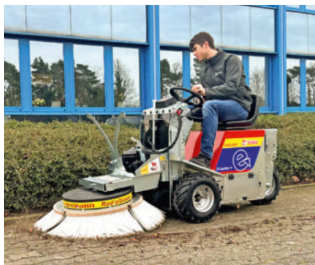
An das neue Trägerfahrzeug E-Lectric lassen sich werkzeuglos Radialbesen, Spaltenschieber, Mulcher etc. anbauen.
